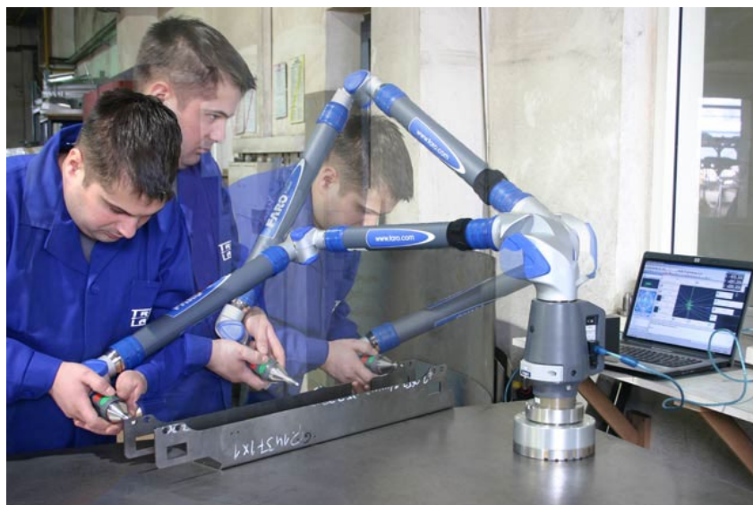
Proces pomiaru geometrii – ramię FARO
